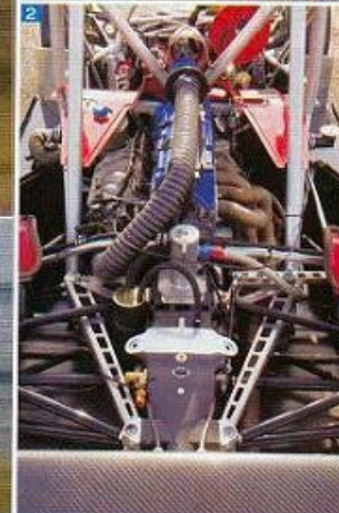
1 - L'aile de la Funyo est rapportée, en porte-à-faux. 2 - La boîte est porteuse mais a besoin pour cela de renforts. 3 - Le comportement est handicapé par un manque d'accord entre avant et arrière. De conception simple, la Funyo est également moins chère.
