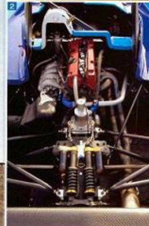
1 - Plus physique, la Norma est en contrepartie la plus efficace du lot. 2 - Les combinés amortisseurs sont signés Oram. Ils sont réglables en compression et détente. 3 - Le Norma est dotée d'un poste de pilotage à gauche. C'est plus pratique pour un novice, mais cela peut handicaper les trajectoires.
